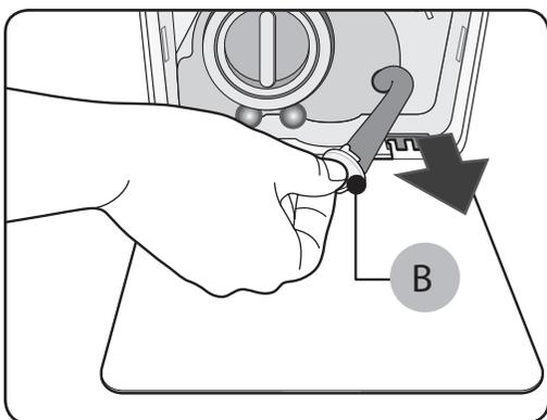
3. Appoggiare un contenitore ampio e vuoto intorno al tappo e stendere il tubo di scarico di emergenza nel contenitore trattenendo il **tappo del tubo (B)**.
