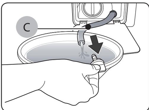
4. Aprire il tappo del tubo e lasciare defluire l'acqua attraverso il **tubo di scarico di emergenza (C)** nel contenitore.
